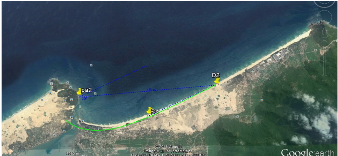
Hình 3-4. Dự báo vị trí đường bờ khi chưa có công trình, PA 2
