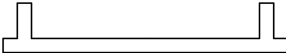
Hình 13. Sơ đồ kết cấu bê tông của kênh thu nước
