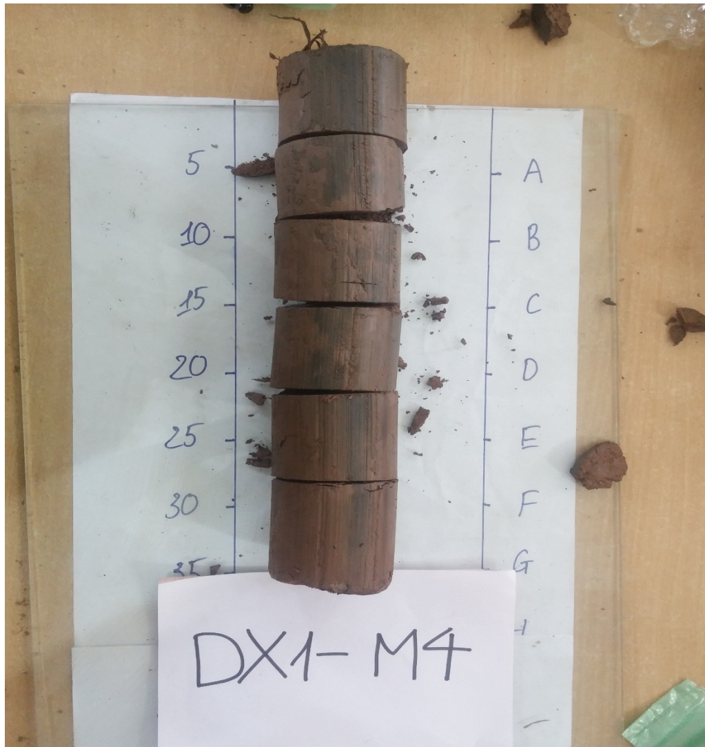
Hình 2.3 : Cắt mẫu thí nghiệm có chiều dài 5cmx5cm
