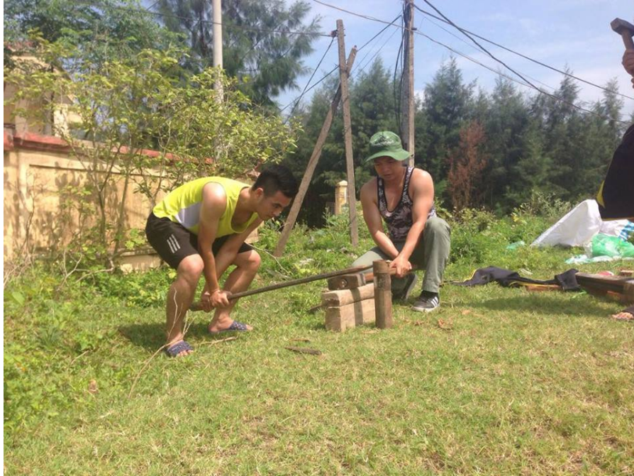
Hình 2.2 : Lấy ống đất chứa cỏ
