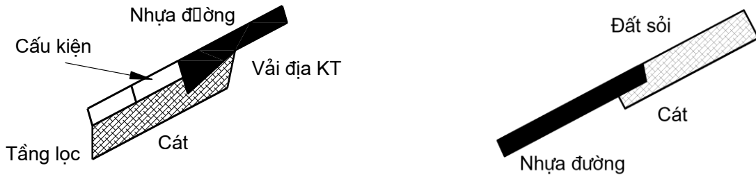
Hình 15 (tiếp theo) - Một số loại kết cấu chuyển tiếp thường sử dụng trong thiết kế đê biển
